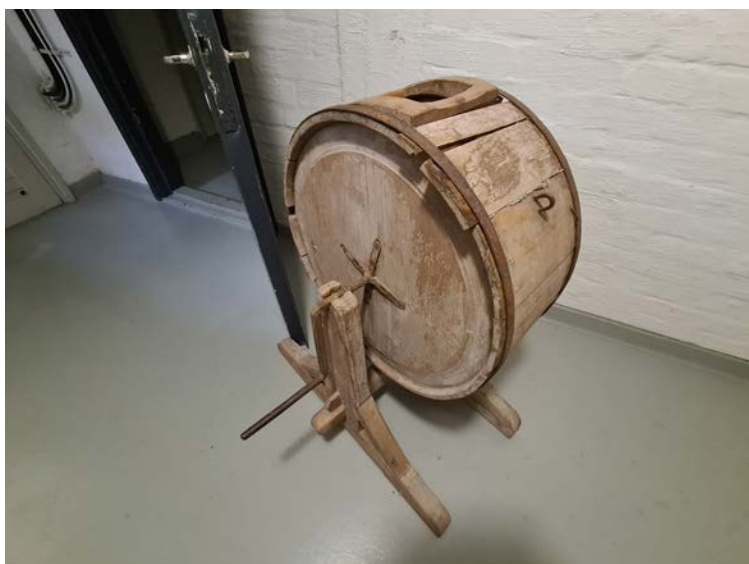
Kuva: 161. Asuntoloiden tiloissa on runsaasti vanhaa ja osin alkuperäistä meijerikoulun välineistöä. Kuvassa esimerkkinä Asuntola 1:n kellarissa sijaitseva puinen, kampikäyttöinen kirnu.
